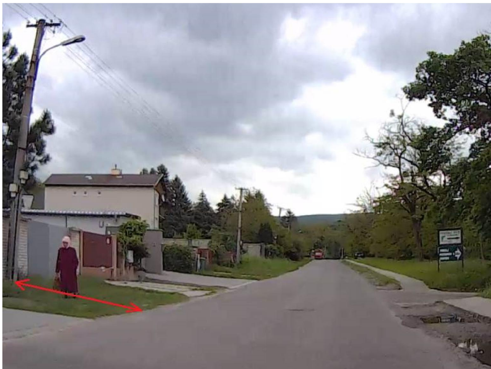
Obr. 21 Distribučné stožiare sú ďaleko od okraja osvetľovanej komunikácie – Ulica Nová
